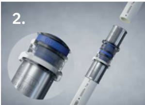
2. Rohr bis zum Anschlag in Fitting einstecken. Das Sichtfenster zeigt, ob es richtig sitzt.
